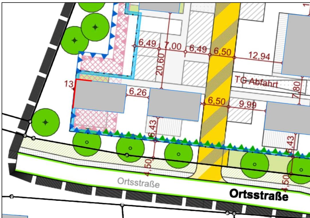
Abbildung 8: Kennzeichnung der Fassaden an denen Schallschutzmaßnahmen notwendig sind
